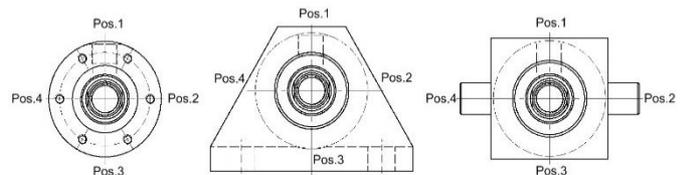
Soll der Anschluss beispielsweise um  $90^{\circ}$  im Uhrzeigersinn gedreht werden, so muss bei Bestellung „Hydraulikanschluss in Pos.2“ angegeben werden.
